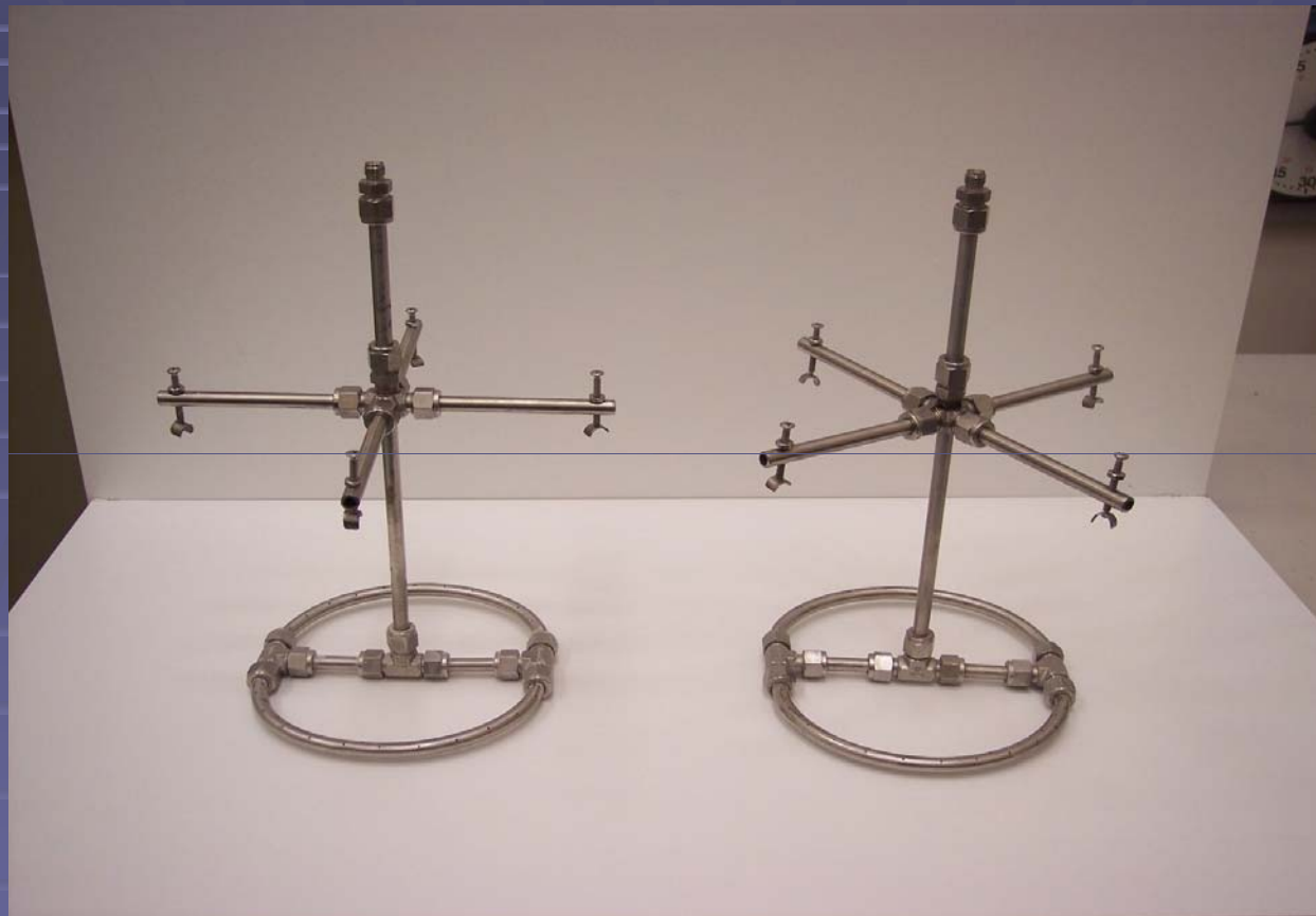
Diffuseurs d'air utilisés
