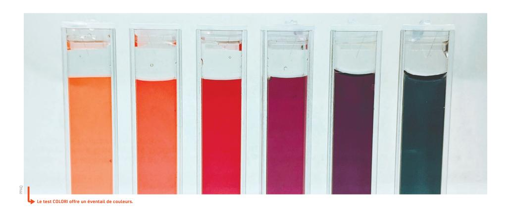
« Ça ressemble à un test de pH pour la piscine, explique le professeur de chimie de l'Université de Montréal et cocréateur du test COLORI, Jean-François Masson. Il n'y a pas d'instrument qui est utilisé. C'est un réactif qui change de couleur selon les profils de saveurs qu'il y a dans la sève d'érable. Les producteurs ajoutent des gouttes de sève au réactif, qui changera du rouge au bleu selon la présence de molécules qui sont associées à des profils de sirop d'érable. »
