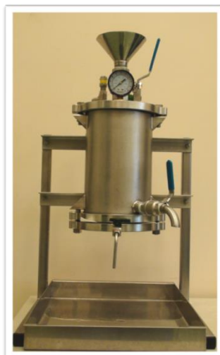
Figure 3 : Unité de filtration à l'échelle pilote utilisée pour la production du sirop d'érable
