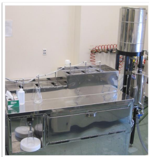
Figure 13. Évaporateur électrique à l'échelle pilote utilisé pour la production du sirop d'érable
