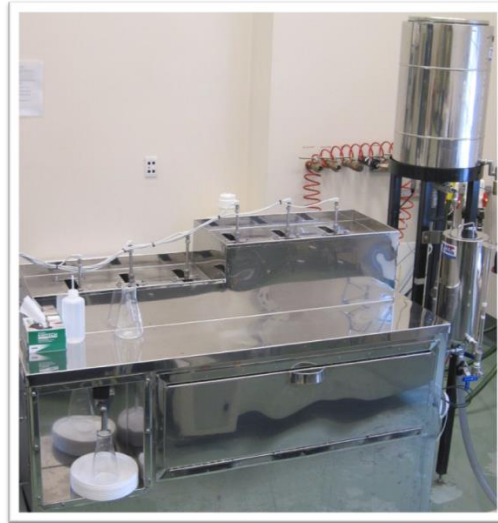
Figure 2. Évaporateur électrique pilote EP-2 utilisé pour la production du sirop d'érable
