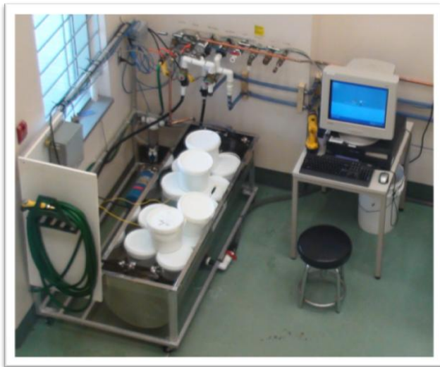
Figure 12. Système de décongélation à l'échelle pilote
