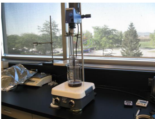
Figure 7. Dispositif utilisé pour l'évaluation de l'efficacité du système rotatif en mode préventif pour le contrôle du niveau de la mousse
