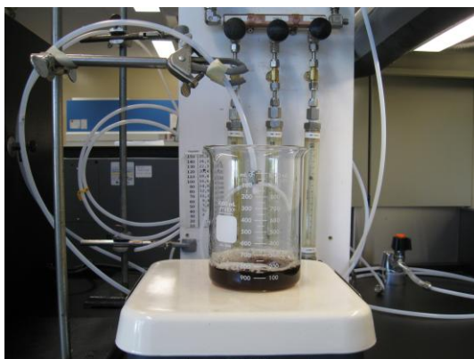
Figure 5. Dispositif utilisé pour l'évaluation de l'efficacité du jet d'air comprimé pour le contrôle du niveau de la mousse
