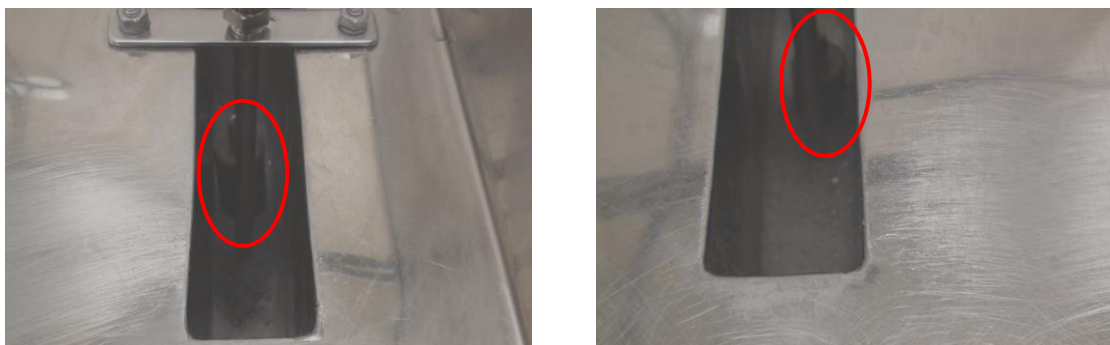
Figure 15. Morceaux de bois barré installés dans les casseroles de l'évaporateur pilote
