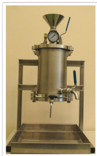
Figure 14 : Unité de filtration à l'échelle pilote utilisée pour la production du sirop d'érable.
