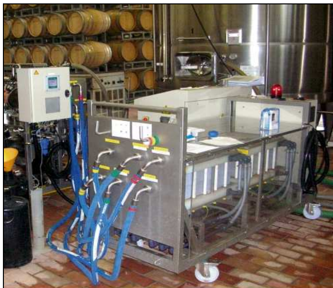
Figure 6 : Électrodyaliseurs pour l'ajustement du pH du vin.
